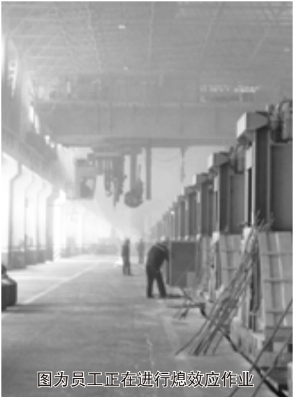
图为员工正在进行熄效应作业
