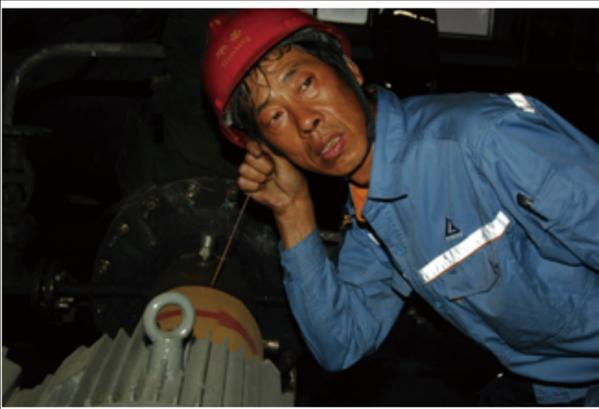
近日，公司以项目制改善和现场管理提升为抓手，深入推进精准管理，各二级单位、车间细化现场管理方案，班组成员通过看、摸、听等对设备进行安全检查，确保设备稳定运行。图为炭素厂员工使用螺丝刀通过声音判断风机轴承运行情况。
