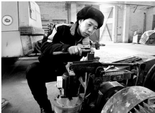
近日,中州铝建土工车间强化设备维护,重点查找检修设备深层次隐患,确保检修设备时刻处于良好备用状态。图为设备维护责任人对石灰炉检修起重设备卷扬机液压抱闸系统进行现场维护整改。申洪波摄
