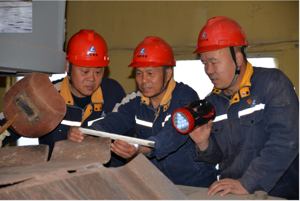
►开年以来,中铝矿业洛阳公司坚决贯彻落实中铝矿业“提产、提质、降本、保供”工作总要求,针对设备设施故障和升级改造,坚持以自主维修为主,3月份,该企业供矿作业区组织焊工、钳工对部分设备自主实施维修改造,共节约成本近13万元。图为破碎班组织工修复1号破碎机重板链条。
