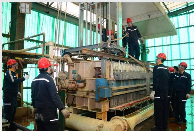
▲近日,中铝铝业自主研发压滤机自动清洗装置正式投入使用。该装置投运后,清洗压滤机滤布作业由原来的人工操作转变为自动化操作,不仅有效提高劳动生产率,还显著增强了操作的安全性。图为中铝铝业员工在对清洗装置进行安装调试。
