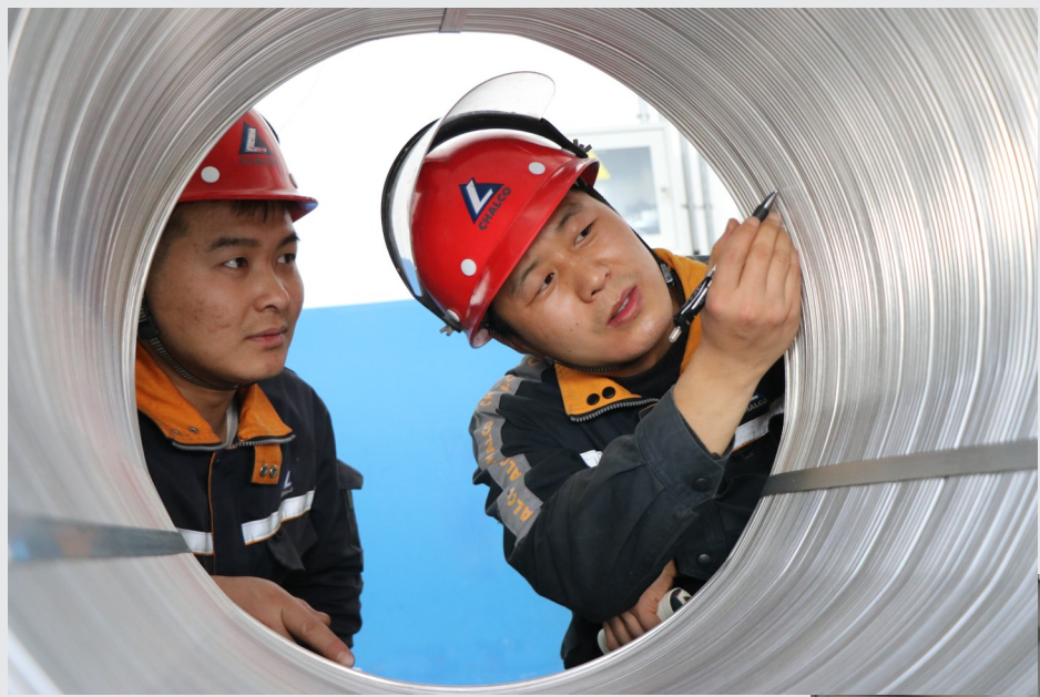
►近日,云铝阳宗海3003高端系列铝合金产品试生产取得一次性圆满成功,产品合格率达100%,加快了云铝股份向高附加值合金产品转型升级的步伐。图为员工在检查圆铝杆外观质量。 郭庆荣 赵梦卿 摄影报道
