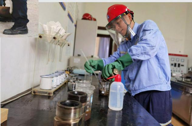
▲近期,遵义铝业全体干部员工始终保持昂扬的斗志,脚踩干劲,努力做到“干”字当头、“实”字为要、“快”字为先,在狠抓落实上下功夫,在解决问题上求突破。图为该公司氧化铝厂员工在做进厂矿石对比溶出实验,寻求最佳溶出条件,以进一步降低铝矿耗、碱耗、石灰消耗综合成本。魏萍 摄影报道
