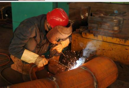
中铝山东恒成厂铆焊事业部党员在疫情防疫和复工复产“集结号”吹响的第一时间,冲锋在前、战斗在前,奉献在前。自复工以来,铆焊事业部成立了党员突击队,对重点设备冷却项目进行生产突击,突击队克服工期紧、焊接难度大等难题,保证项目顺利推进,同时节约成本3万余元。图为铆焊事业部党员对筒体内扬料板进行焊接作业。 苏亚楠 王晓鹏 摄影报道
