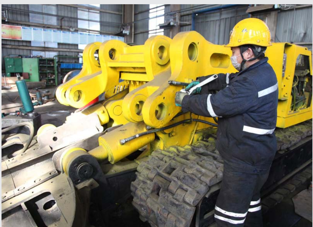
▲近期,宁夏能源在做好疫情防控工作的同时,积极协调各企业做好复工复产工作,重点指导王洼煤业利用现有在岗职工,做好各类设备检修、维护、保养等工作,为保障企业全面复工复产、快速进入正轨循环作业打下坚实基础。图为王洼煤业员工正在加速检修综掘机。 赵 翔 张 成 摄影报道
