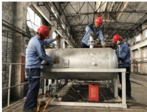
突然发现打药除草设备需要大量的压力空气，内燃机车需频繁打风，导致打药过程中机车风泵提供的压力空气明显不足，药液喷射的效果及效率都不能达到要求。党员李建民、范吉峰带领员工现场跟车，寻找问题所在，将喷射方法由射吸式改为压送式，利用压力空气将储存罐内药液压送至喷头并雾化，达到药液直接喷洒目的。再次改进后的自动除草剂喷洒设备，既减少了机车风泵的工作量，又提高了工作效率，拓宽了站场喷洒面积，除草时间由原来 40 天缩减至 5 天。
