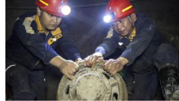
矿业公司猫场铝矿检修班，为了确保1160m中段运输巷的正常运行，组织人员对该运输巷的设备设施进行维护保养，对损坏的矿斗、道叉、滑触线及时进行修理。图为修理工正在对损坏的矿斗进行修复。
