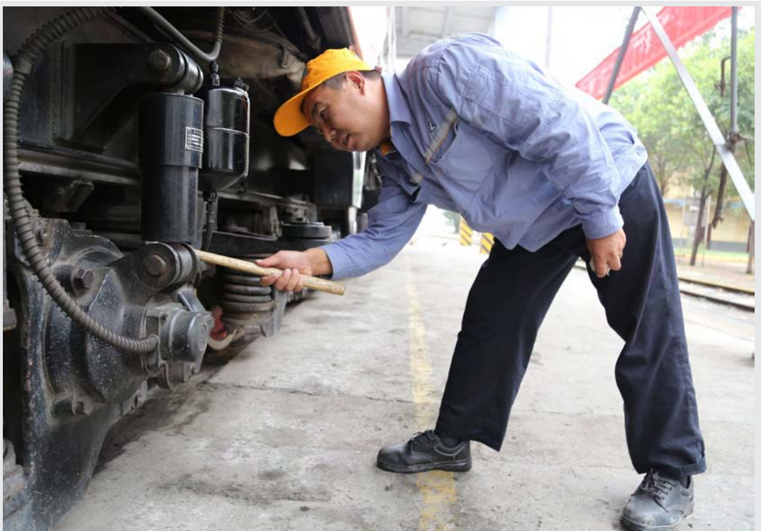
▲今年年初以来，中铝物流中部陆港以“保证设备安全、稳定和经济运行”为目标，建立了以个人点检、专业技术人员巡检、单位负责人定检、职能部门抽检为主的设备管理“四级防线”，使设备始终处于预知、受控之中，确保设备长周期稳定运行。目前，该公司主要设备完好率保持在100%，综合设备完好率达到了97%，特种设备检测率达到了100%，有力地保障了生产经营需求。图为该公司员工在进行内燃机车点检。
