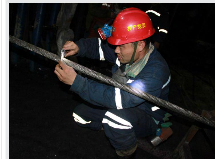
▲今年年初以来,宁夏能源王洼煤业严格落实绞车运行安全系数现场确认制度,坚持每班、每趟都必须由各点安全员对绞车压杠、钢丝绳断丝、断股进行排查确认,发现问题立即停止运行并整改处理。图为该公司当班安全员正在利用游标卡尺确认钢丝绳安全系数。张成 高晓惠 摄影报道
