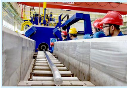
近日,西北铝特种行业铝合金材料产业化项目36MN双动反向挤压热负荷调试成功。该设备从德国引进,产品将主要用于生产大飞机、石油钻探、核工业等领域所需的超高强、高精度铝合金挤压材。当前,西北铝正在抓紧组织系统调试,力争早日实现量产,替代部分进口材料,为企业扭亏脱困、转型升级提供强有力的保障。
