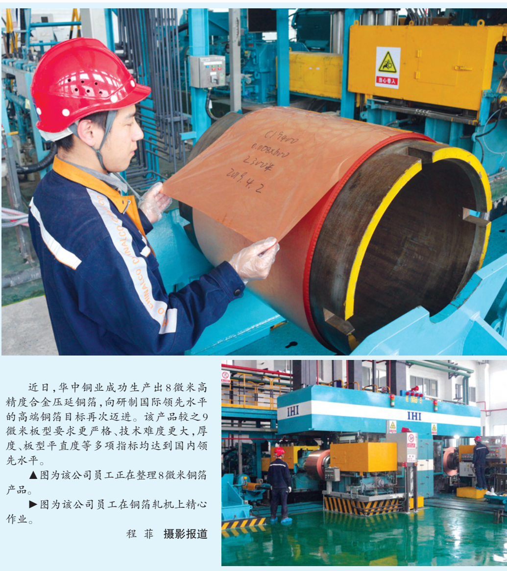
近日,华中铜业成功生产出8微米高精度合金压延铜箔,向研制国际领先水平的高端铜箔目标再次迈进。该产品较之9微米板型要求更严格、技术难度更大、厚度、板型平直度等多项指标均达到国内领先水平。
