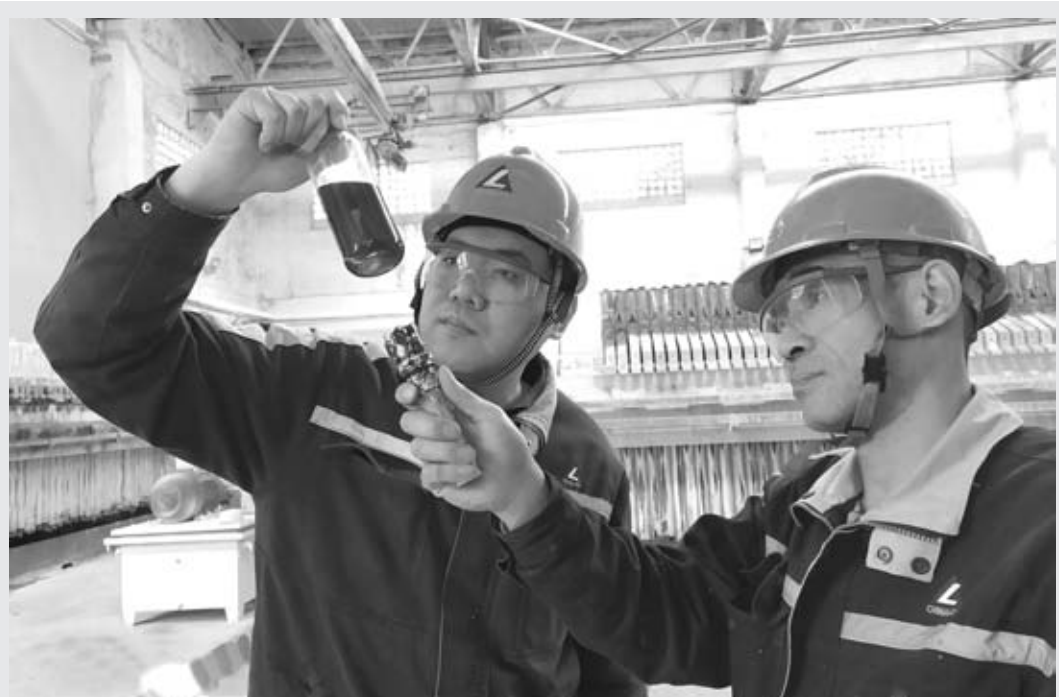
▲近日,为全面打赢安全环保质量攻坚战第二次战役,中铝山东有限公司氧化铝厂通过建立完善的质量控制体系,对生产全过程精准把控,当好质量“卫士”,把好指标关口,确保重点指标始终处于可控状态。图为该厂除杂工区岗位人员正在抽测单车压滤液浮游物情况。
