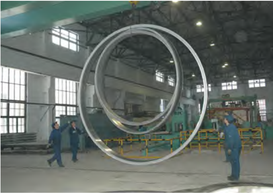
▲图为东轻锻造史上最大直径锻环(外径5150毫米),这也是同时期(2006年)国内最大铝合金锻环。董青 摄
