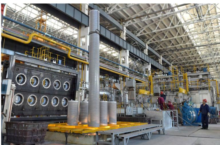
▲西南铝熔铸线员工在吊运刚铸造出的圆锭。 李影摄
