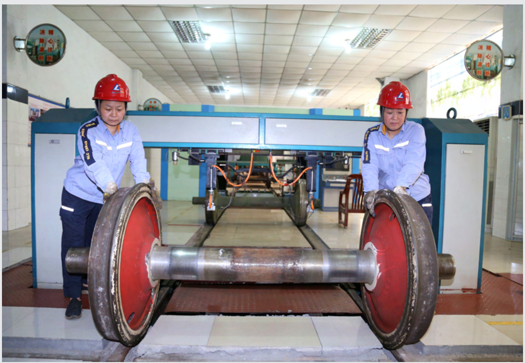
▲近日,为落实安全环保质量责任,中铝物流中部陆港在车辆检修中秉承“质量是生存线、安全是生命线”的理念,精心检修铁道自备车辆,确保生产安全,为物流产业发展提供可靠车体运用保障。图为中部陆港装备技术公司员工正在认真检测铁道车辆轮对。
