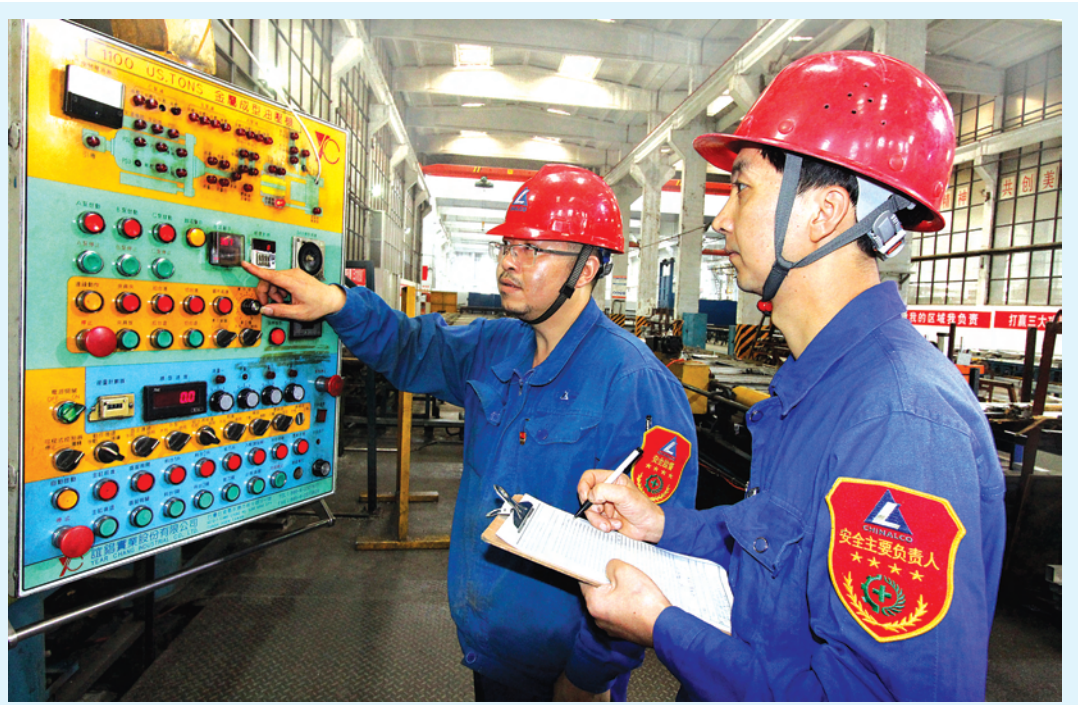
▲贵州铝厂铝合金厂通过认真开展“安全、干净”班组竞赛活动,员工的安全意识、操作行为、安全技能、综合素质等得到明显提升。图为该厂员工近日在交接班时严格控制挤压机油、盛装筒工艺、原料铝棒、产品模具等温度数据,以确保铝合金型材的安全正常生产。
