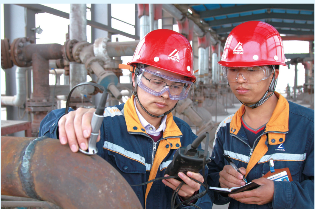
▲今年以来,中国铝业遵义氧化铝采取多种方式发动基层员工开展提质增效活动,确保完成一季度生产经营目标任务。近日,该公司全面梳理优化了溶出机组停机检修环节,成功将检修工期缩短了10个小时。图为该公司员工正在对管道测厚。 卫学敏 吕正彪 摄影报道
