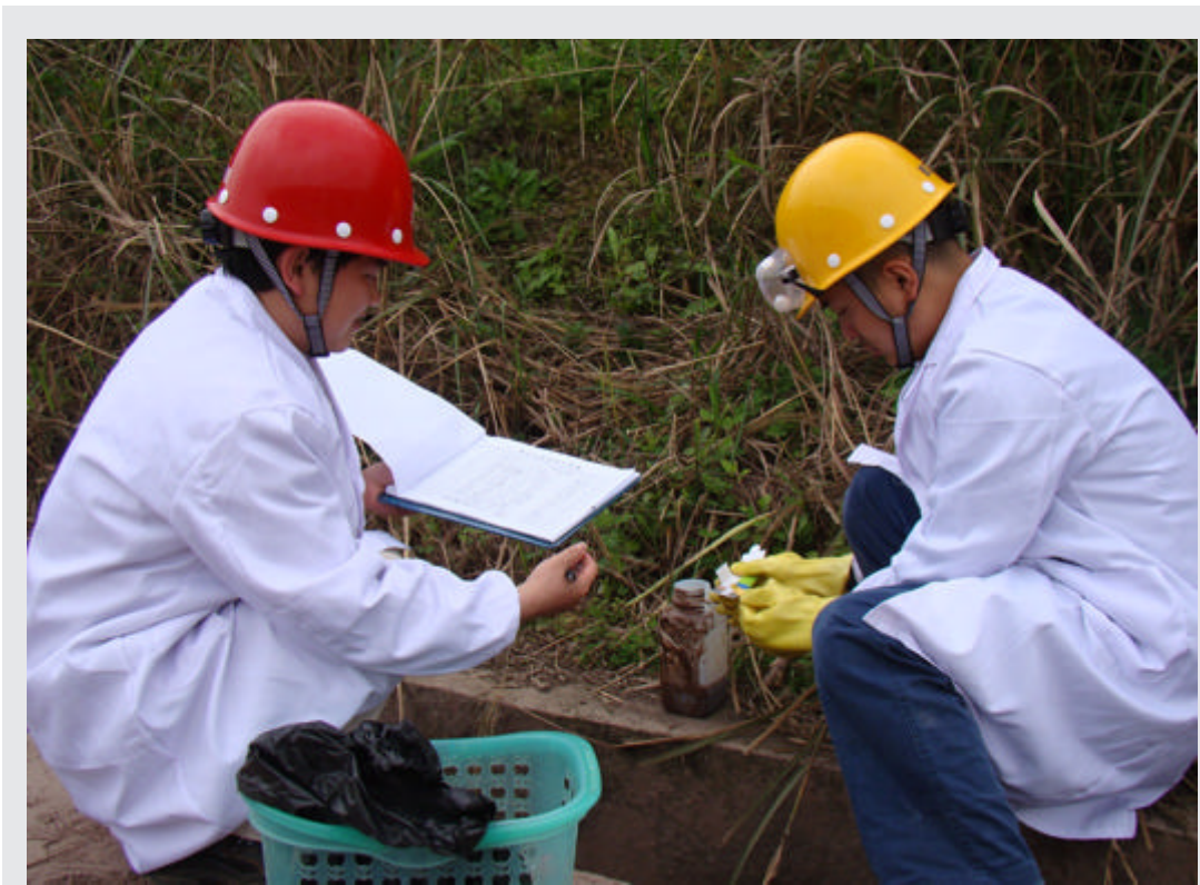
▲近期,贵州持续降雨,遵义氧化铝抓好厂区防洪防汛工作的同时,全力做好赤泥堆场周围防洪沟雨水监测,防止工业水回水外排。图为该公司员工检测赤泥堆场周围防洪沟水质。 樊志 摄
