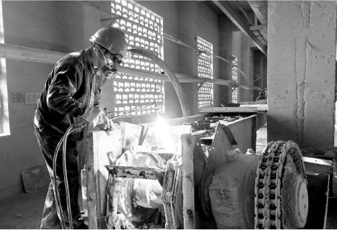
1 月 4 日，第二氧化铝厂综合车间接到熟料车间磨头上碱刮板链条拉断急需抢修任务后，立刻组织人员进行接力式抢修。经过三个班不懈努力，更换了变形的刮板和链条。5 日 8:00，设备恢复正常运行。图为综合车间的员工正在切割变形的刮板。
